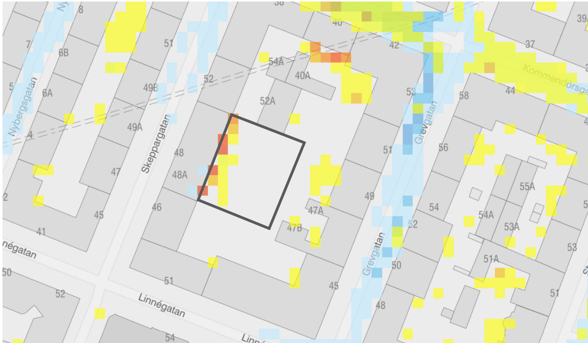
Figur 7-2. Stockholm stads skyfallskartering där ett 100-årsregn simulerats. Flödesvägar redovisas med blått och maxdjup gällande ansamlat vatten redovisas med gult och rött. Gul färg avser ett vattendjup på 0,1–0,3 m medan orange färg avser ett maxdjup på 0,3–0,5 m stående vatten.
