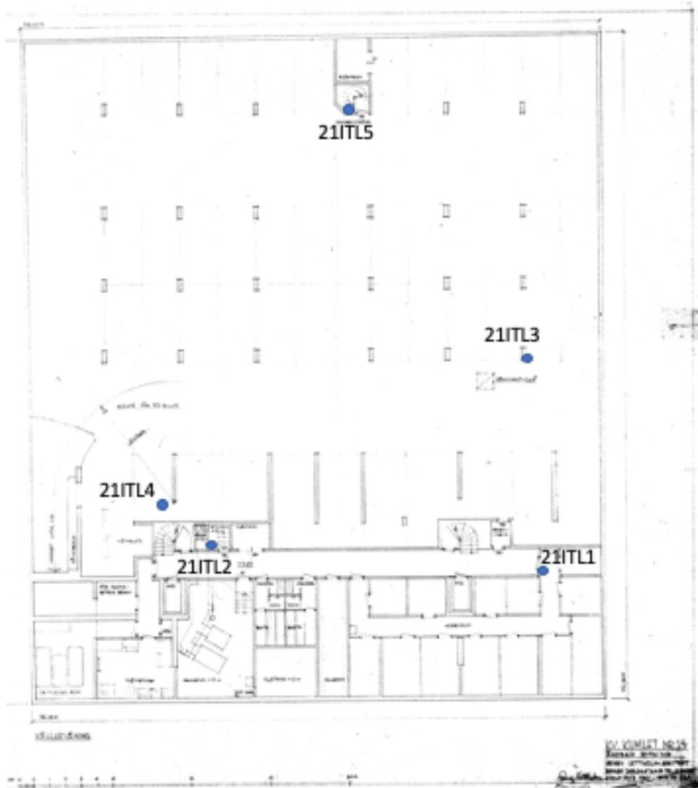
Figur 4. Provtagningspunkter 21ITL1 – L5 inritade på bygglansritning från 1967 av källar- och garageplan vid Kumlet 23.
