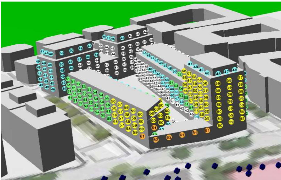
Figur 3 Ekvivalent ljudnivå vid fasad, dBA, Skatepark 15 m från fasad. Placering enligt gällande förslag. Vy från sydöst.
