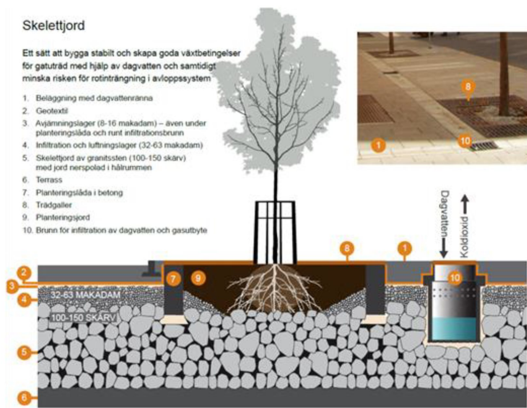
Figur 14 Schematisk illustration över plantering av träd i skelettjord (Stockholm Vatten och Avfall, 2021b)
