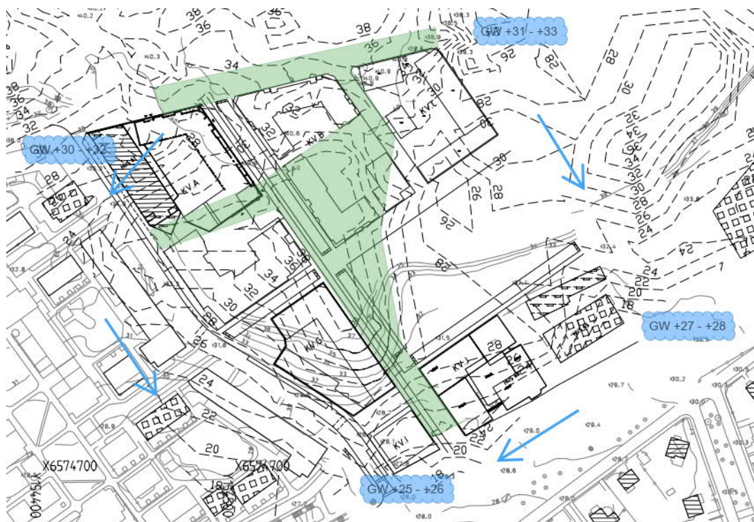
Figur 3. Plan med bedömda bergnivåkurvor (streckade svarta linjer) och planerad kvartersstruktur. Ungefärliga grundvattennivåer och strömningsriktningar visas med blå färg samt område för huvudsakliga grundvattenbarriärer av berg med grön färg.
