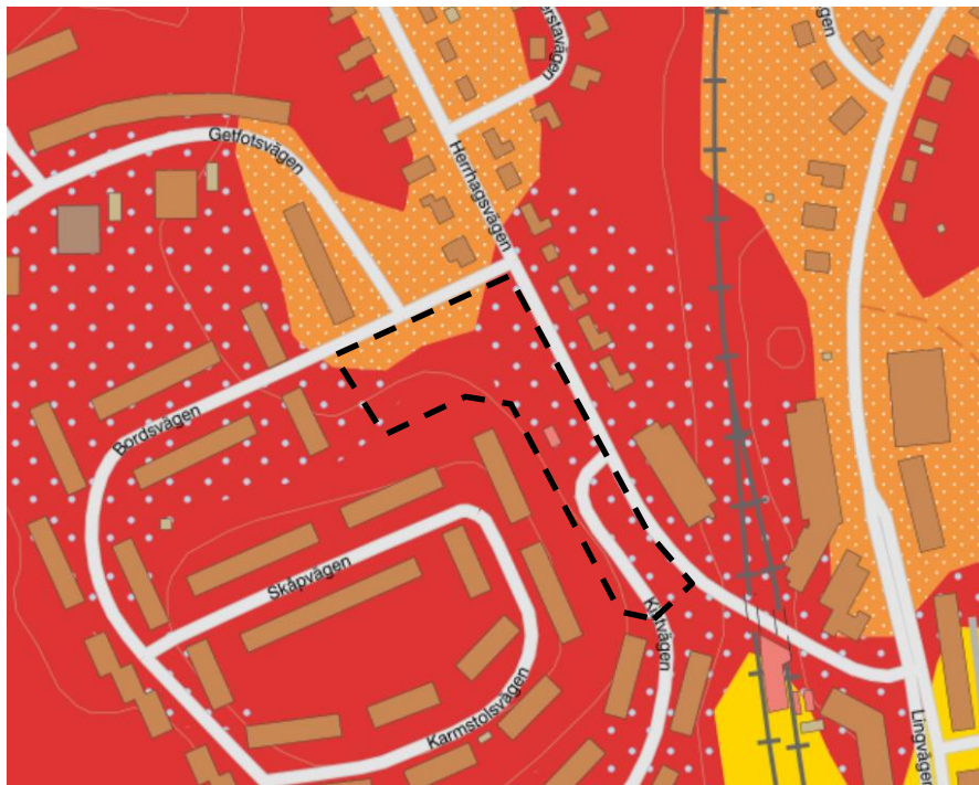
Figur 2. Utdrag ur SGU:s jordartskarta, med provtagningsområdet markerat. Röda ytor utgörs av urberg, röda ytor med ljusblå prickar utgörs av urberg överlagrat av ett tunt eller osammanhängande ytlager av morän, orange ytor med vita prickar utgörs av postglacial sand, gula ytor utgörs av glacial lera.
