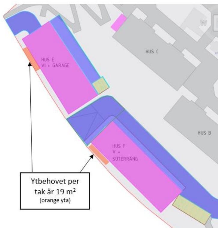
Figur 21. Ytbehov för regnbädd per tak är 19 \text{ m}^2 och har markerats i figuren (orange yta).
