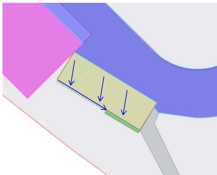
Figur 24. Föreslagen avvattning för avvattningsområde 4. Dagvattnet avleds ytligt till en nedsänkt regnbädd. Den utritade regnbädden i figuren är ca 3 \text{ m}^2 . Gröna streckade linjen är föreslagna öppna rännalsplattan, som leder vattnet vidare mot regnbädden.
