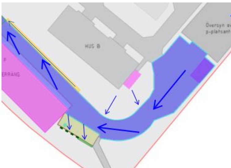
Figur 25. Föreslagen avvattning för avvattningsområde 6a och 8a. Gul polygon är utritad infiltrationsstråk och är ca. 27 m 2 .
