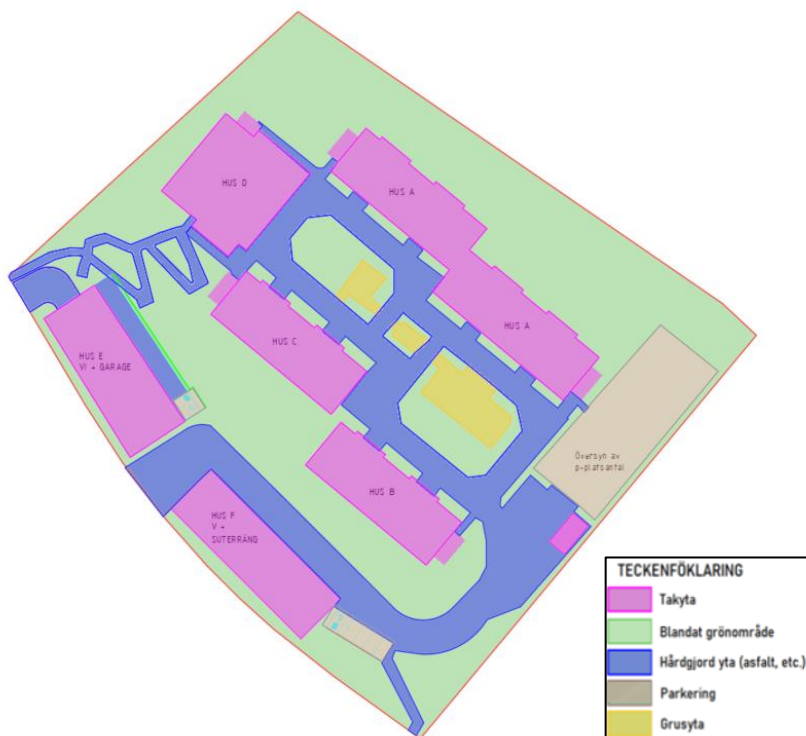
Figur 9. Planerad utformning av Paradsängen 1. Nya huskroppar (Hus E och Hus F) placeras i den södra och sydvästra delen av området. Infarten delas upp i två och den befintliga parkeringen försvinner. Under Hus E planeras garageplan, bjälklagsgården syns i grön linje norr om huskroppen.
