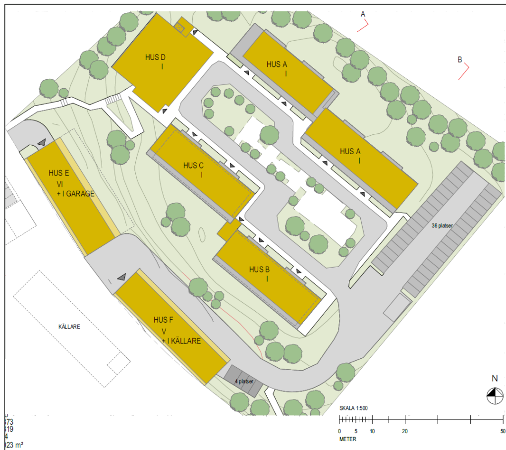
Figur 3-1 Fastigheten med de planerade byggnaderna dels som påbyggnader på befintliga byggnaderna (hus A-D), dels som helt nya byggnader (hus E-F).
