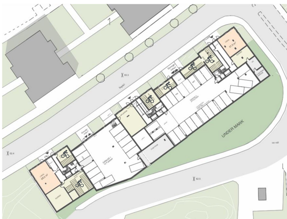
Figur 5. Utformning av parkeringsgarage samt placering av cykelrum.
