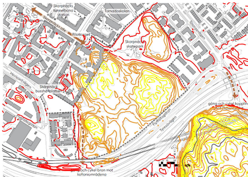
Figur 3 Kartbild över planområdet med nivåkurvor befintlig mark, där röda linjer redovisar nivåer upp till +29, orange linjer nivåer upp till +34 och gula linjer upp till +38.
