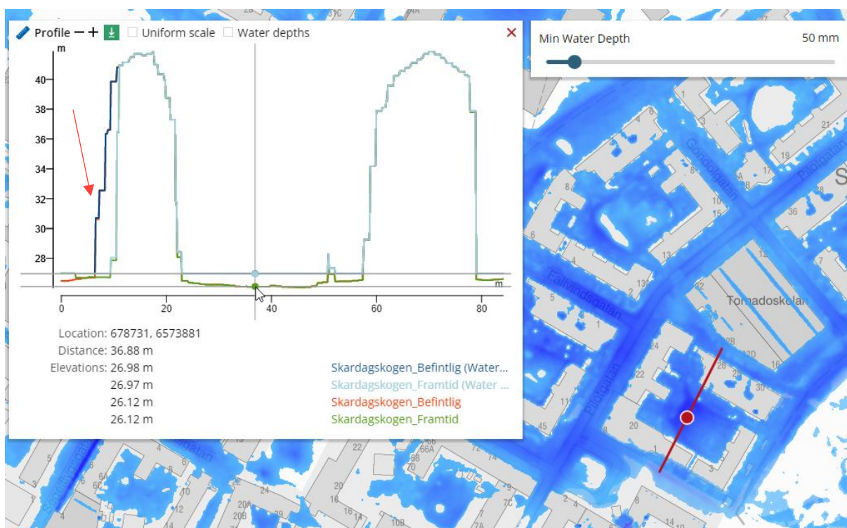
Figur 12. Sektion över Piloten 3 som visar oförändrad dämningnivå inom kvarteret före och efter exploatering. Röd pil i figuren indikerar det område som i Figur 11 redovisar en falsk ökning i vattennivå till följd av exploateringen.
