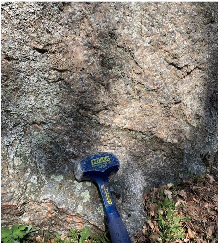
Figur 5-4: Närbild från provtagningsområde 4. Medel- till grovkornig sedimentgnejs, främst fältspat och kvarts.
