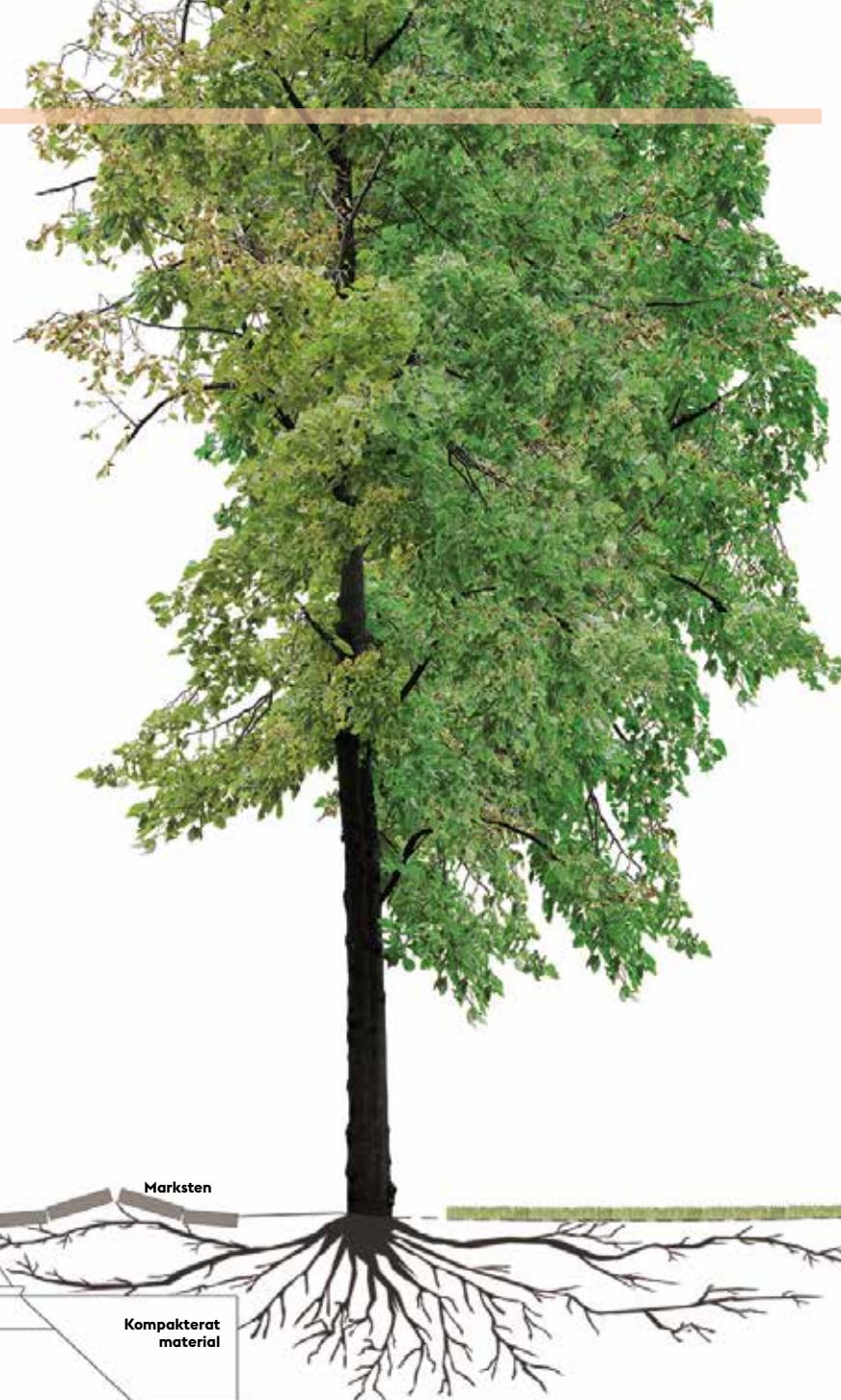
En kompakt växtbädd med begränsad volym gör trädet utvecklas dåligt och kan ge problem med rötter som lyfter markbeläggningen.
