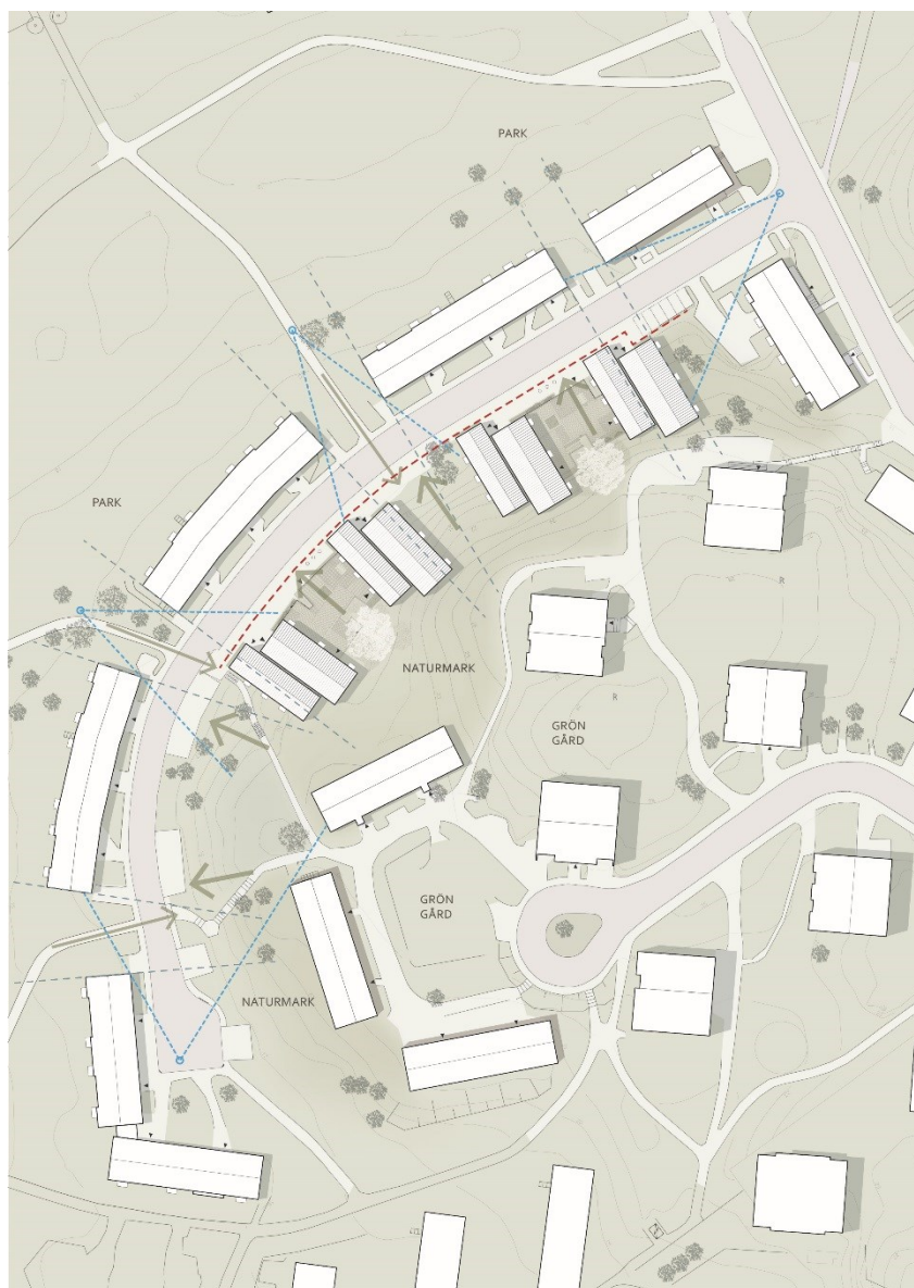
Figur 20. Situationsplan över planförslaget som visar dess koncept där placeringen av byggnaderna förhåller sig till siktlinjer, gröna släpp och omgivande bebyggelse. Bild: Arkitektstudio Witte.
