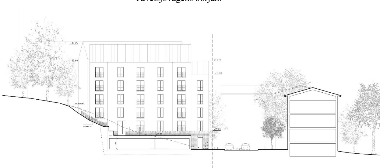
Figur 24. Sektion som visar höjdförhållandet med omgivande befintlig bebyggelse och souterrängförhållandet i landskapet. Bild: Arkitektstudio Witte.
