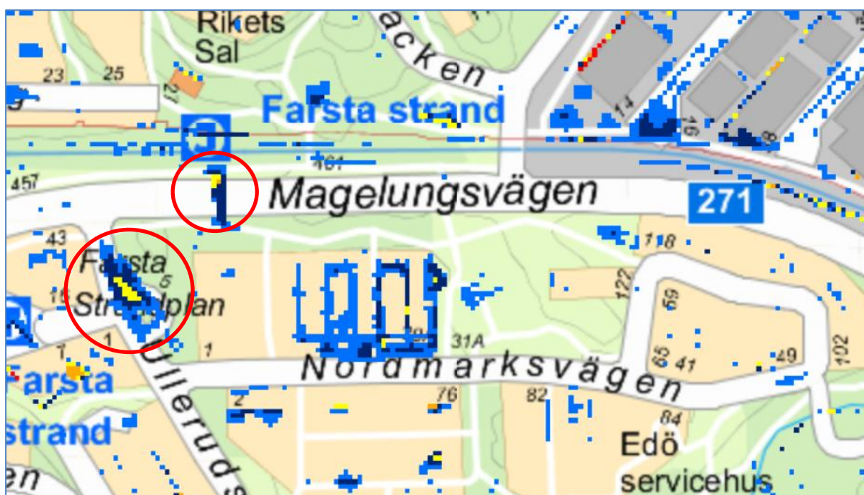
Figur 2-2 . Skyfallskartering Stockholm stad, scenario C – ogynnsamt scenario, max vattendjup, 2015. Färgkodning av simulerat vattendjup enligt följande: Blå 0,1-0,3 m, mörk blå 0,3-0,5 m, gul 0,5-0,7, orange 0,7-1,0, röd >1,0.
