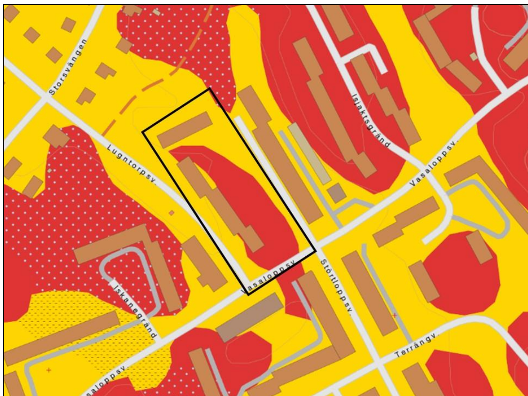
Figur 3-5. Jordartskartan från SGU (2019a). Utredningsområdet är markerat med en svart rektangel. Gul färg indikerar glacial lera och röd färg indikerar berg.
