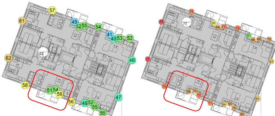
Figur 5 Hus 9. Något högre nivåer redovisas i beräkningsmodellen då denna ej tar hänsyn till inverkan av balkongplatta, tätt räcke eller absorbenter i tak.
