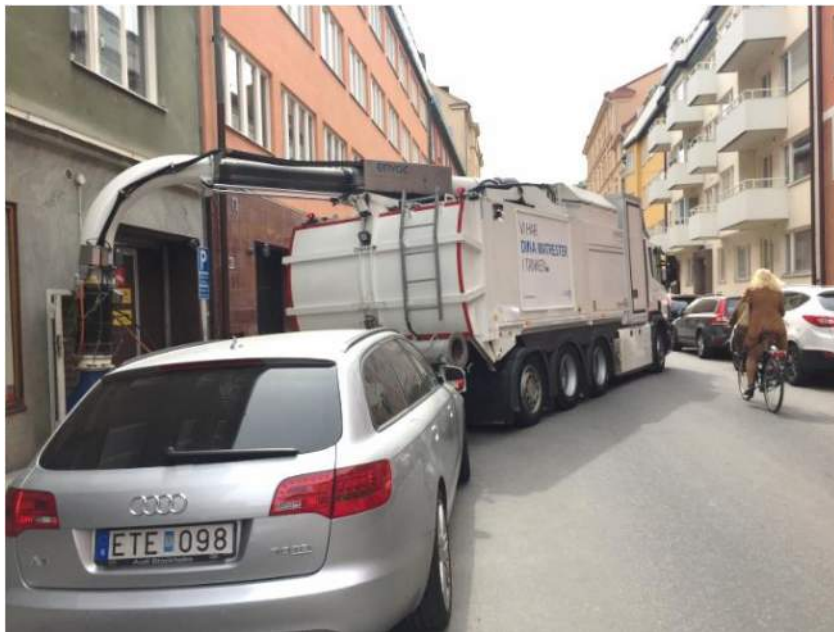
Figur 10 Mobilsug hämtar från dockningspunkt i fasad. Foto: Daina Millers-Dalsjö, Urban Earth
