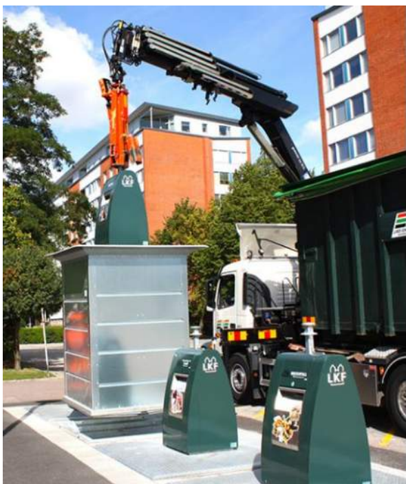
Figur 11 Underjordsbehållare – tömning med kranbil. Källa: Sansac
