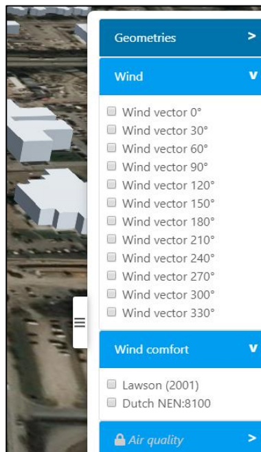
Figur 3. Kontrollpanelen som visar de två huvudsakliga valen, resultat från olika vindriktningar samt vindkomfort där samtliga riktningar aggregeras.
