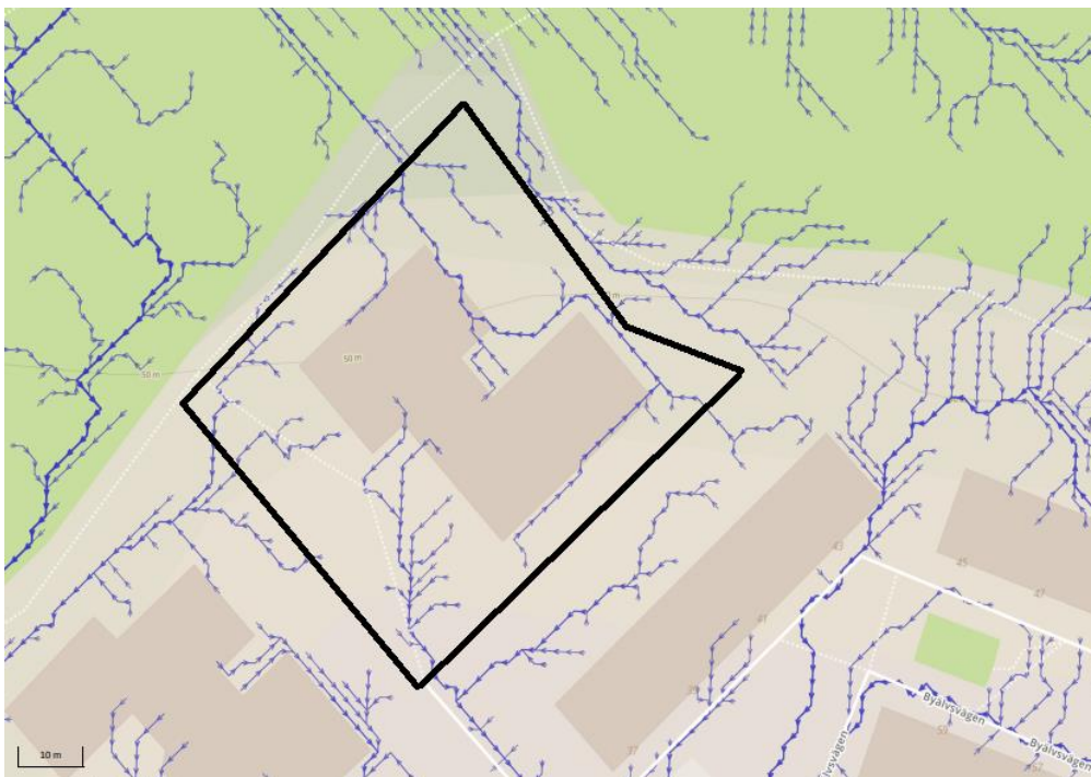
Figur 9. Befintliga, ytliga rinnstråk inom planområdet. Utdrag ur SCALGO Live. Ungefärligt planområde markerat med svart linje.
