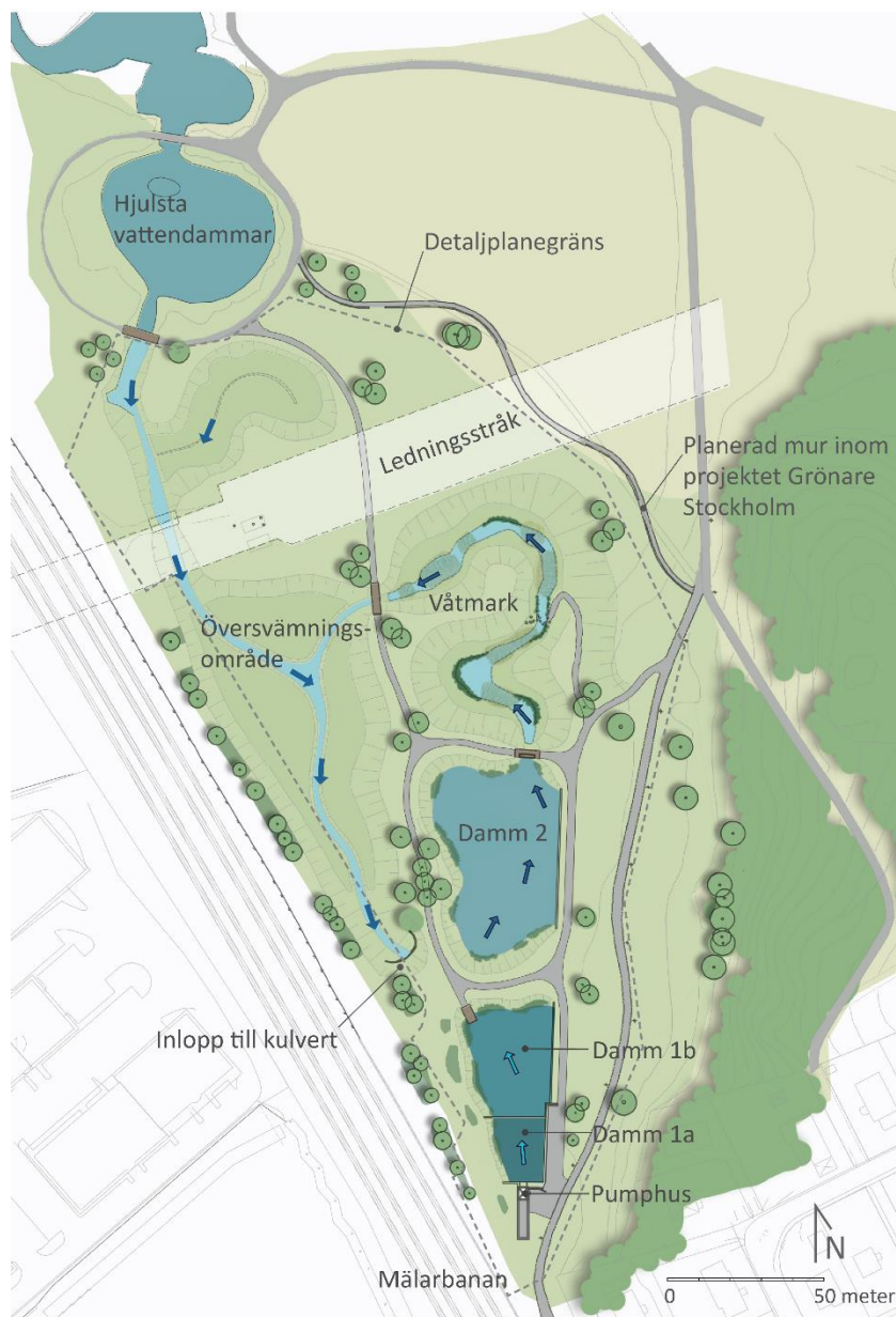
Möjlig utformning av dammar och översvämningssyta. Pilarna visar vattnets flödesriktning (Ramboll).
