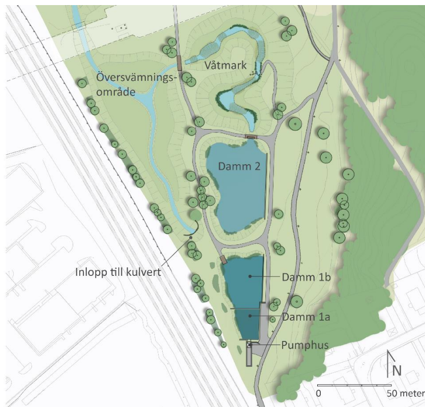
Utsnitt ur illustrationsplan med planerade dagvattenanläggningar (Ramboll, 2021).
