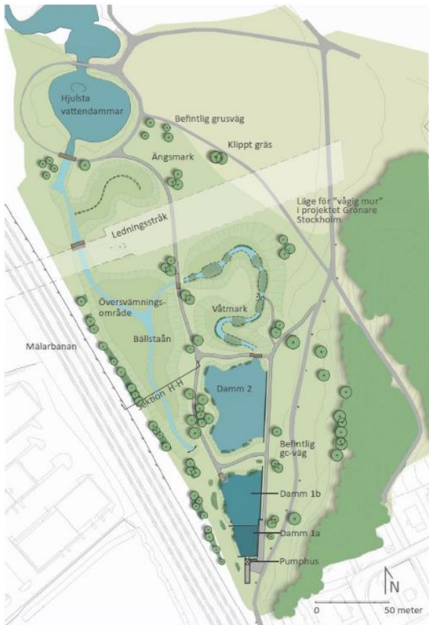
Figur 3. Illustrationsplan för Tenstadelens dagvattenpark. Illustration: Ramboll [4]
