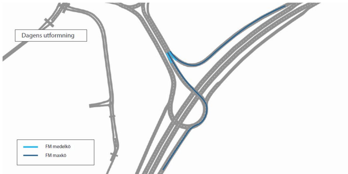
Figur 8. Köbildning på ramperna med dagens utformning under förmiddag maxtimme år 2023, se även Figur 7
