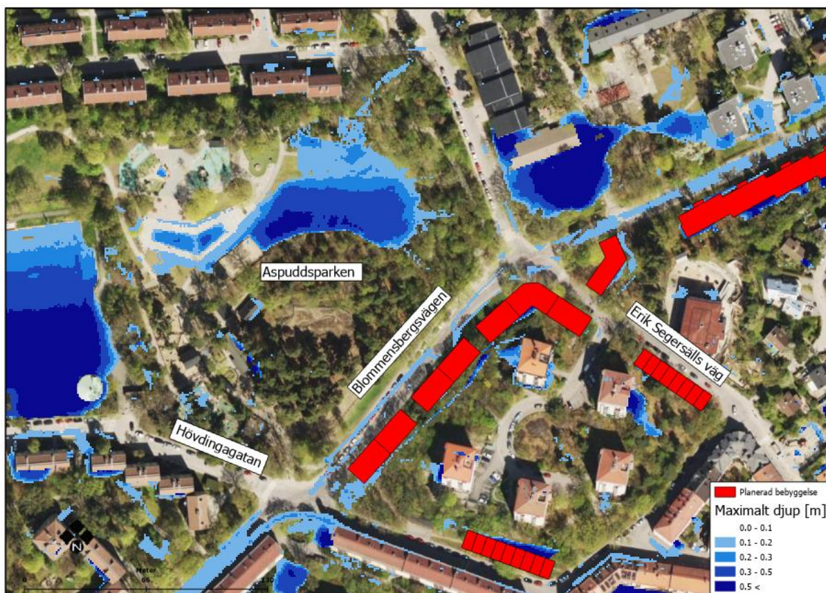
Figur 4. Maximalt djup för framtida förhållanden för ett klimatkompenserat 100-årsregn.
