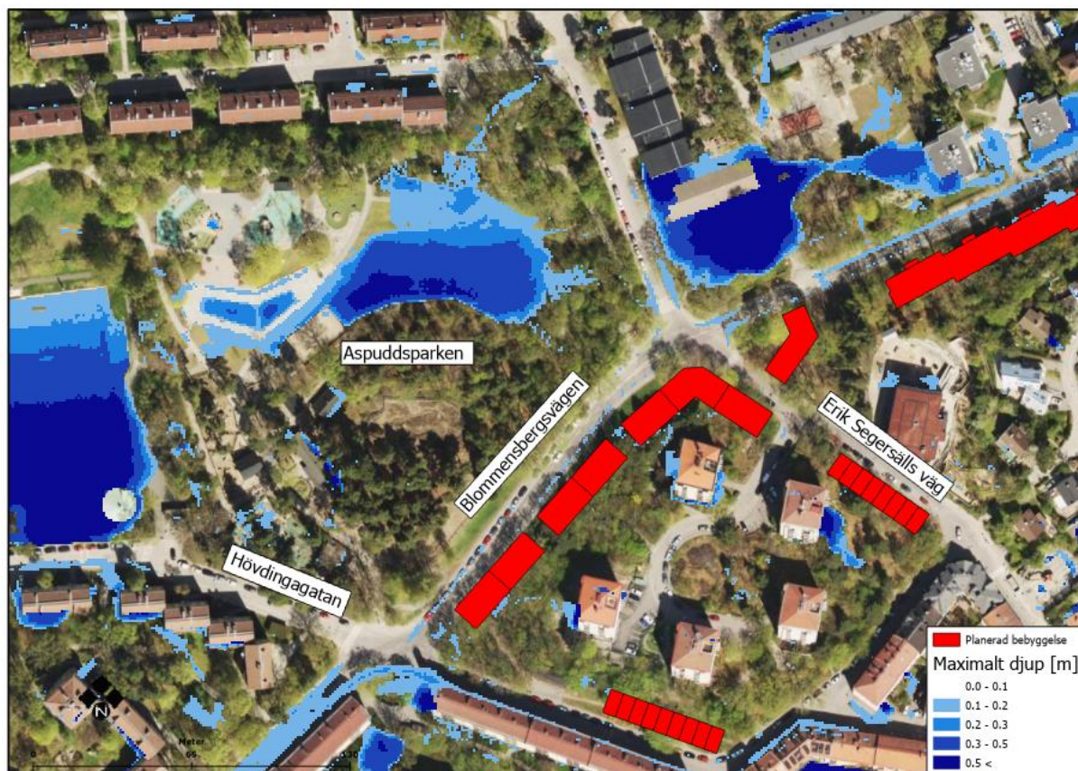
Figur 3. Maximalt djup för befintliga förhållanden för ett klimatkompenserat 100-årsregn.
