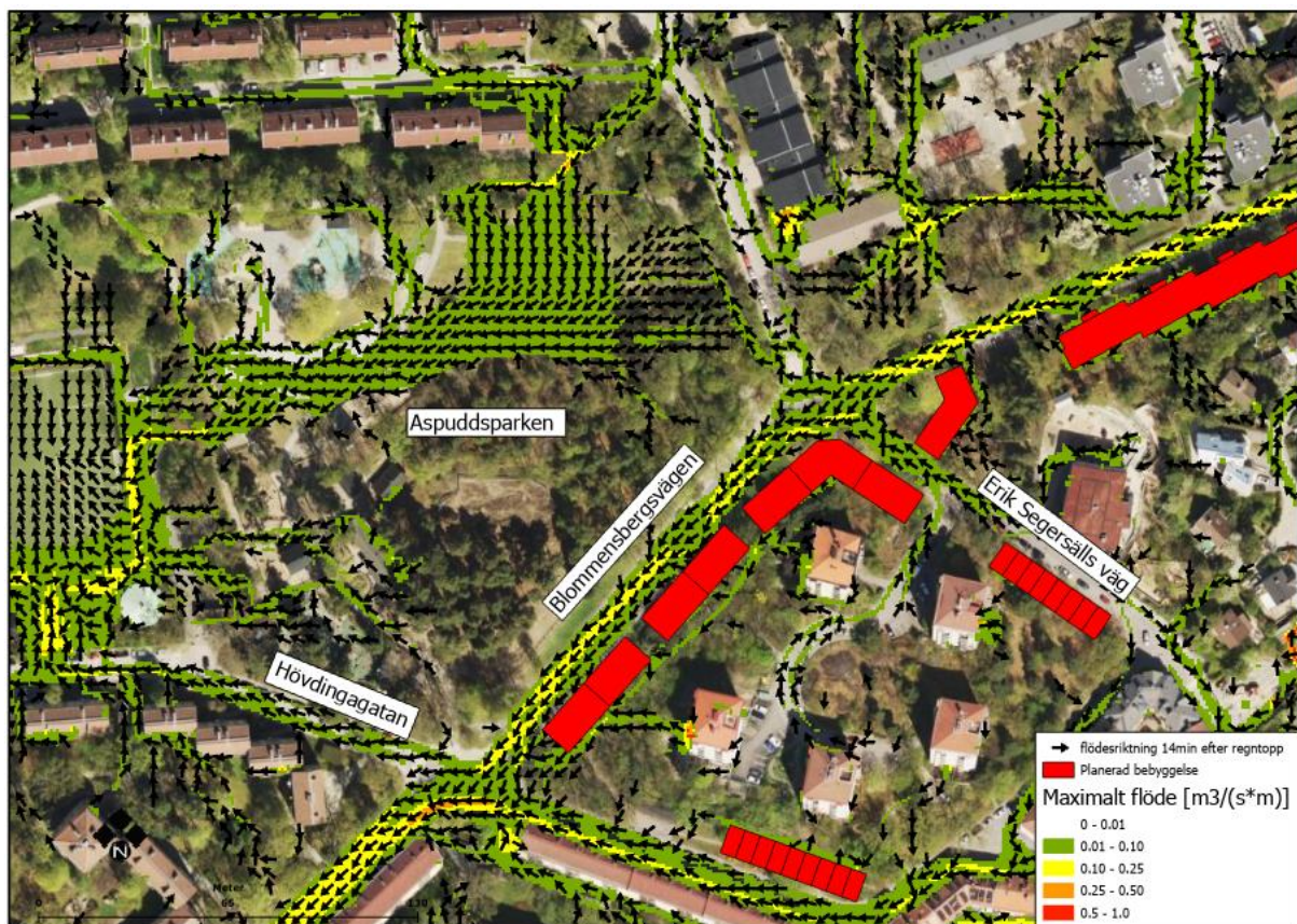
Figur 2. Maximalt flöde för ett klimatkompenserat 100-årsregn för framtida förhållanden.
