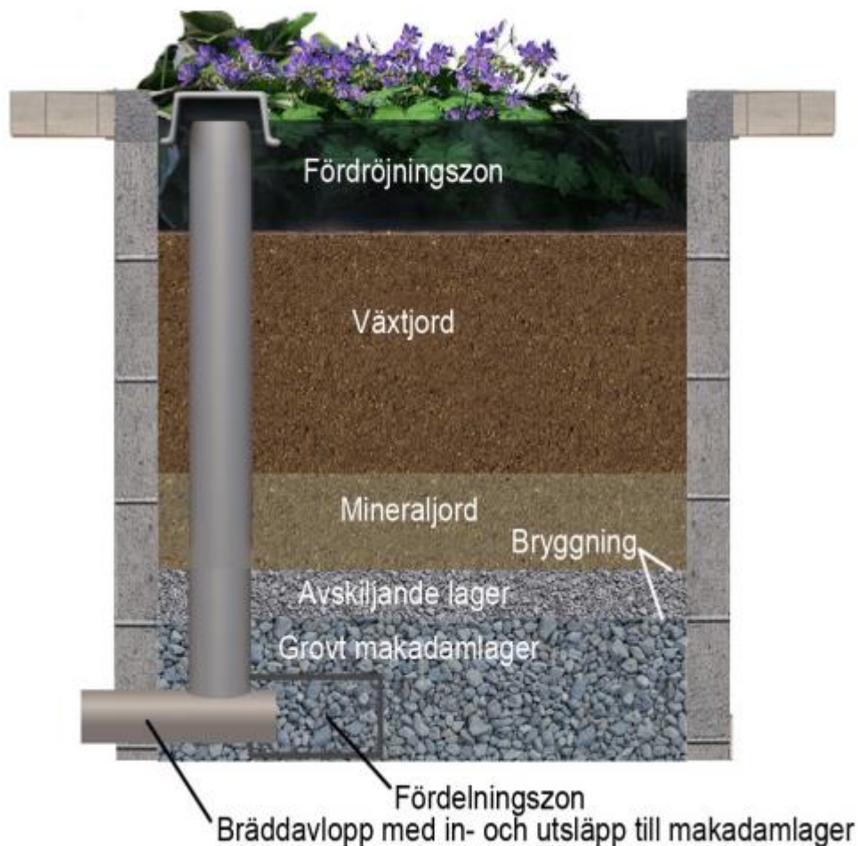
Figur 5-1. Exempelillustration av hur en regnbädd kan byggas upp (Figur från Movium Fakta #2 2015).
