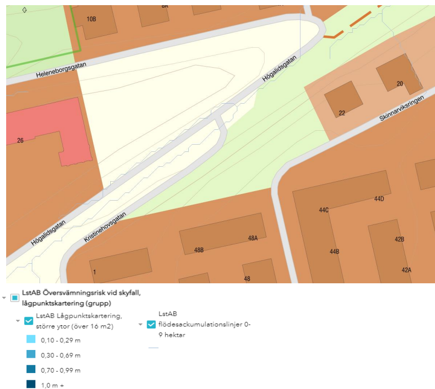
Figur 8. Lågpunktskartering med flödesackumulationslinjer (Länsstyrelsen Stockholm).
