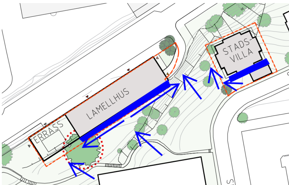
Figur 13. Helhetsbild dagvattenhantering efter exploatering. Blå plar avser ytavrinning.
