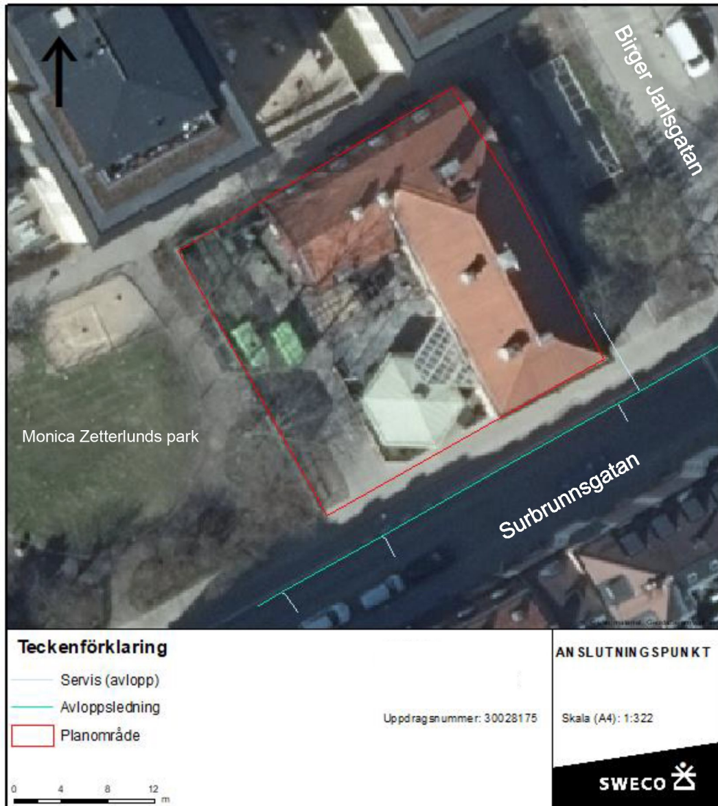
Figur 8. Anslutningspunkten (servis) från planområdet till det allmänna ledningsnätet.
