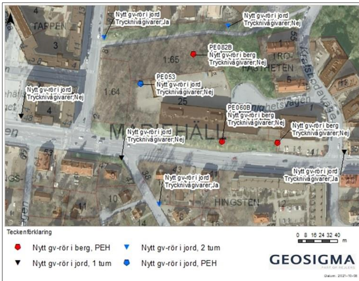
Figur 9. Förslag på ungefärlig placering av nya grundvattenrör i jord och berg.
