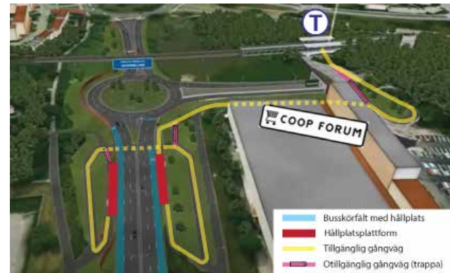
Busskörfält, hållplatslägen och gångvägar vid bytespunkt Vinsta-Johannelund (vy söderut på Bergslagsvägen).
