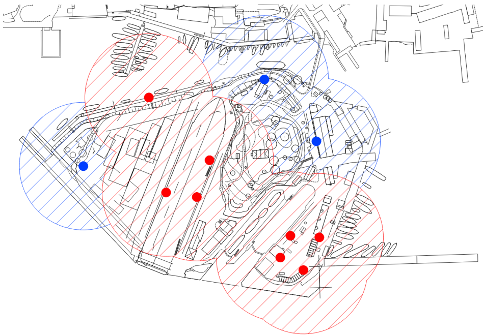
Figur 4. Röd markering visar befintliga brandposter. Blå markering visar föreslagna placering av nya
