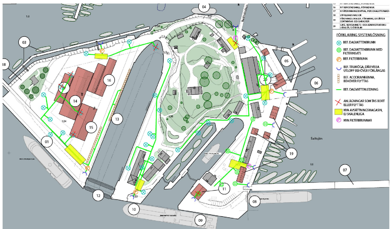
Figur 12. Systemlösning utifrån befintligt system med tillägg av avsättningsmagasin i gult. Underlag Illustrationsplan från (2022-03-05). Vissa befintliga utlopp kommer behöva förlängas i och med tillbyggnad av kajer
