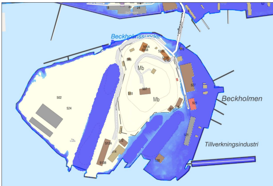
Figur 10. Landområden inom detaljplanen som ligger under den rekommenderade lägsta grundläggningsnivå på 2,7 meter enligt RH2000 markeras med blått.
