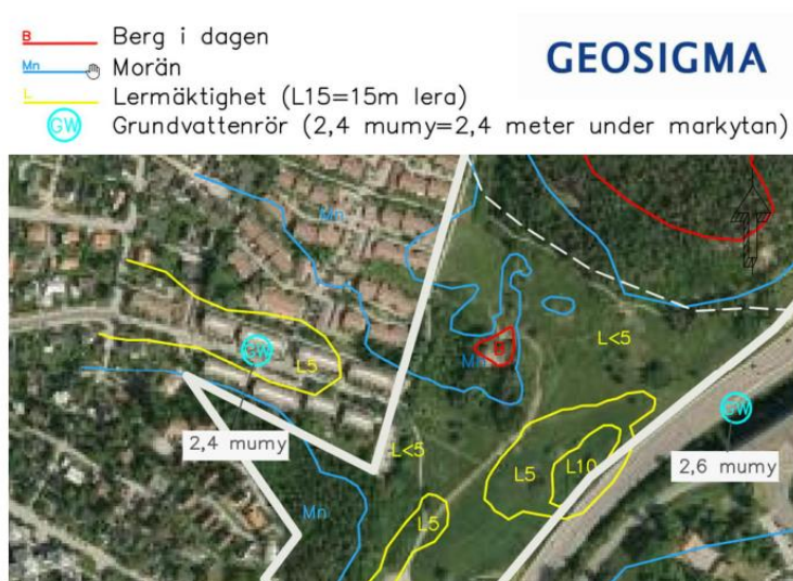
Figur 7. Karta över de ytlagaste jordlagren samt bedömda lerdjup, urklipp från Spångadalens översiktlig geoteknisk beskrivning, upprättad av Geosigma för Stockholm stad, daterad 2016-12-13.
