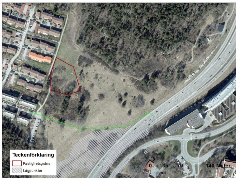
Figur 12. Befintligt ledningsnät för dagvatten, gröna linjer.
