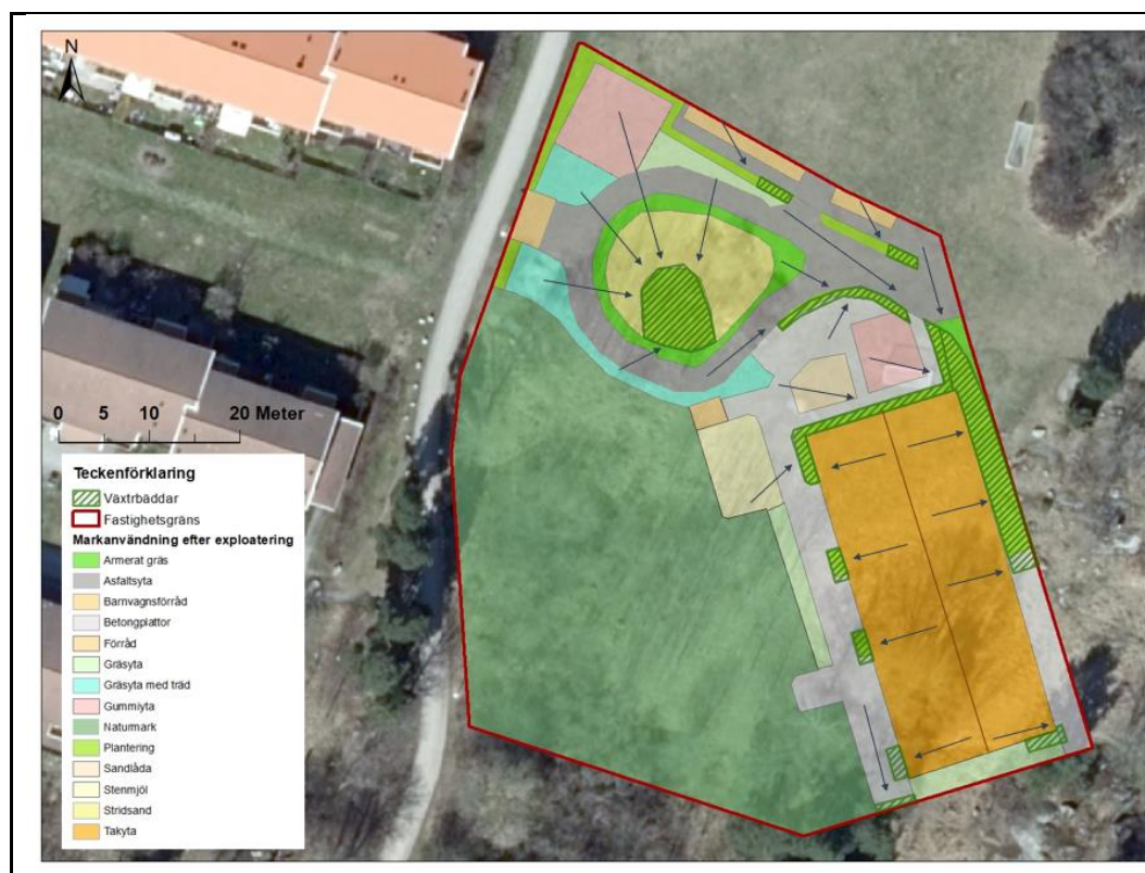
Figur 19. Översikt av dagvattenhanteringen. Placering av växtbäddar utgår från skisser från landskapsarkitekt
