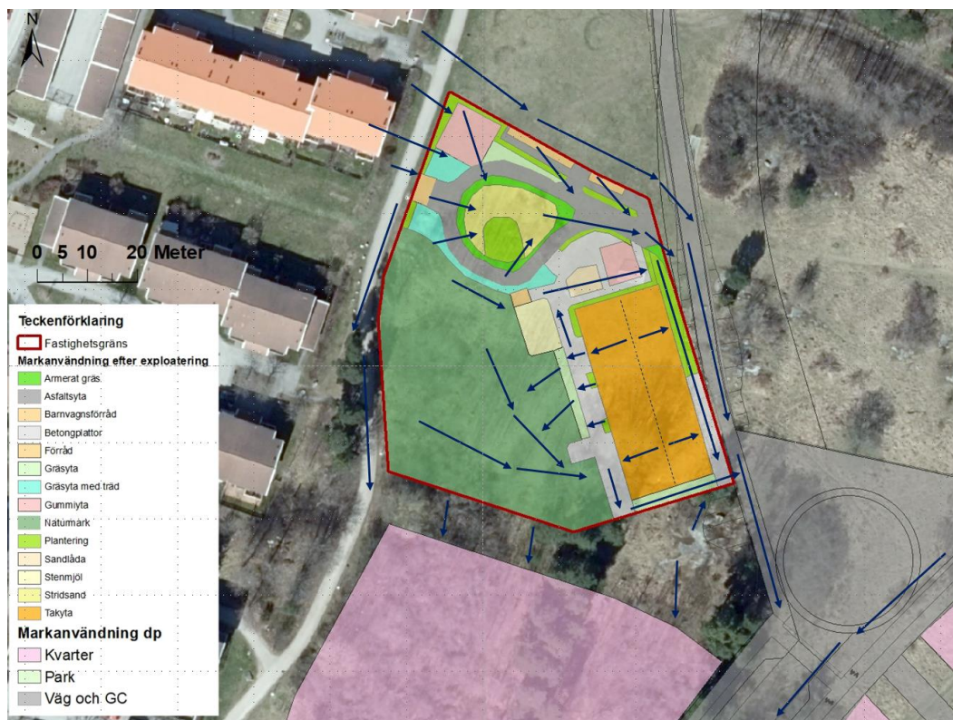
Figur 21. Flödesvägar planerad situation (blå pilar). Ungefärlig planområdesgräns markerad med vinröd polygon.
