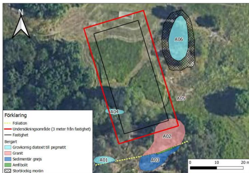
Figur 8. Förskolebyggnad med samtliga berghällar, (PM Geoteknik/Bergteknik WSP, förhandskopia 2022-03-03)
