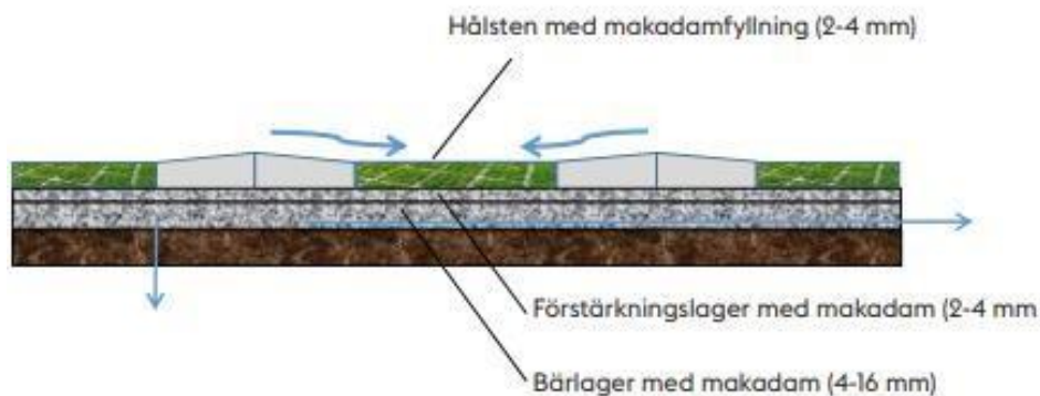
Figur 12. Principskiss för gräsarmerad betonghålstensbeläggning. 21
