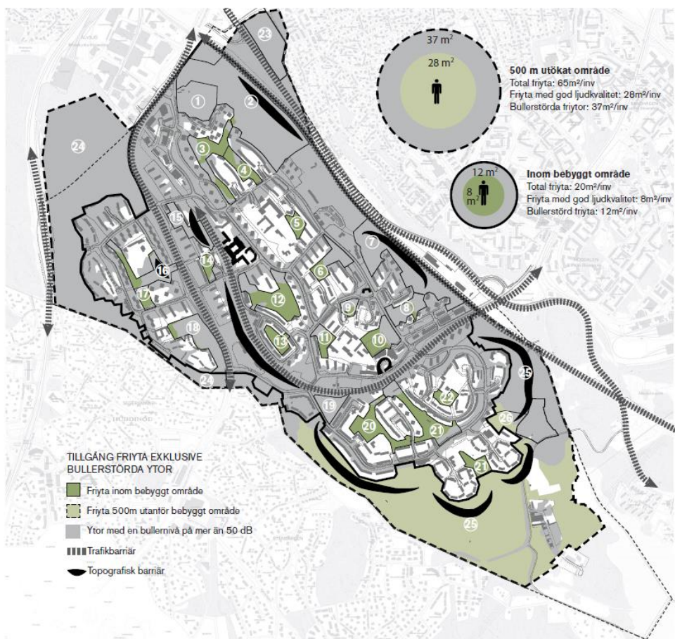
Kartan illustrerar med grön färg tillgängliga friytor med godtagbar ljudnivå i Hagsätra och Rågsved samt med grå färg ytor med en bullernivå över 50 dB.
