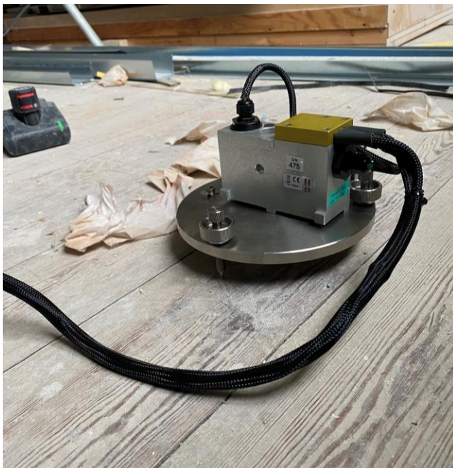
Figur 11. Placering av mätaren i mätpunkt B på byggnadens träbjälklag.
