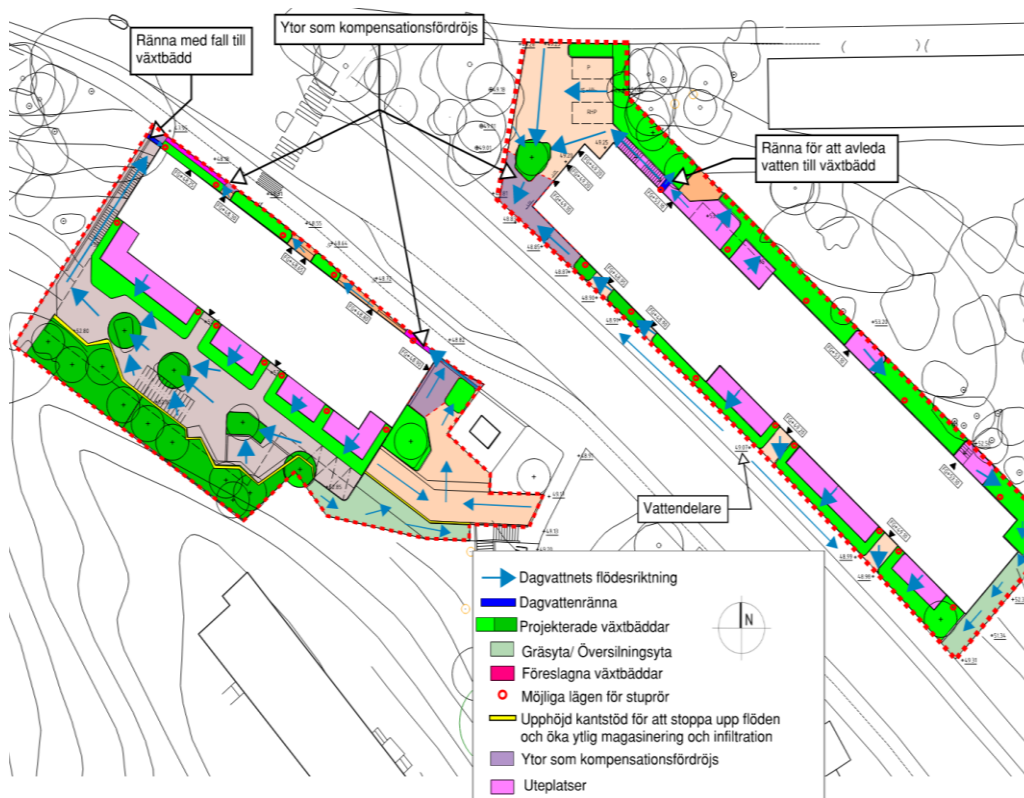
Figur 19. Dagvattenhantering i nedsänkta växtbäddar enligt projekterade höjder. Flödespilar i blått visar hur vattnet leds till föreslagna dagvattenanläggning
