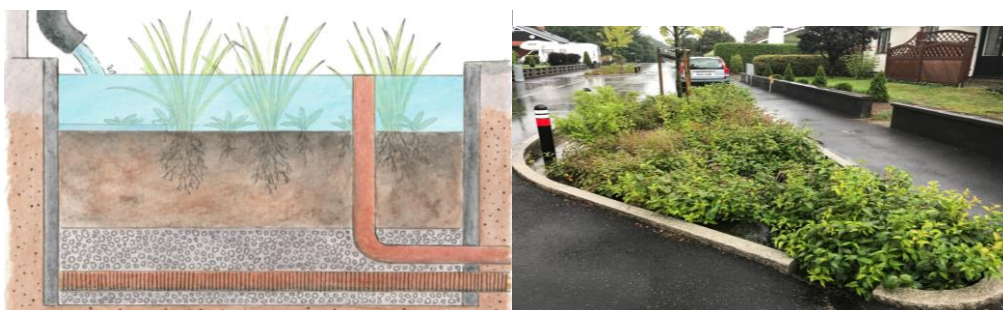
Figur 18. Principskiss för en växtbädd till vänster och exempel på nedsänkt växtbädd med kantläpp till höger (VA-guiden och Blomqvist)
