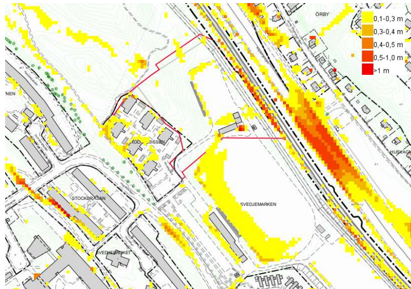
Utdrag ur stadens skyfallskartering. Gula-röda områden indikerar risk för stående vatten vid skyfall. Ju rödare färg, desto mer vatten ansamlas.
