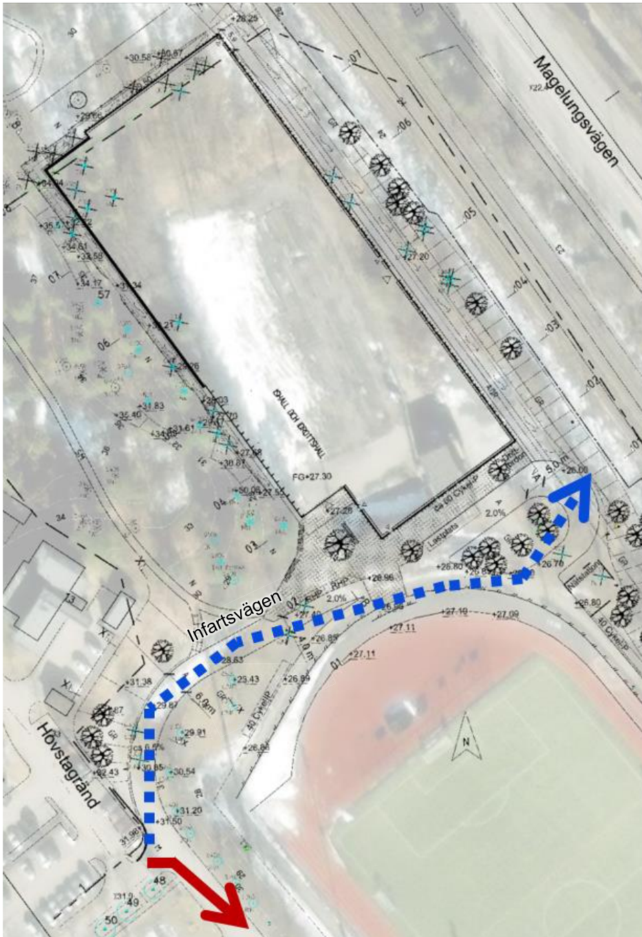
Figur 20. Skiss av framtidsscenariot (alternativ 2) där infarten till den nya is- och idrottshallen sänks. De blå pilarna representerar vattenflödet i det nya scenariot, medan de röda pilarna visar hur vattnet skulle ha flödat om vägen inte hade ändrats.
