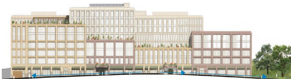
Figur 4. Byggnaden sett från gatuvy från väst till öst. Sydlig riktning till höger i bild och nordlig åt vänster. Blåa flödespilar illustrerar bedömd avrinning längst med Långa gatan
