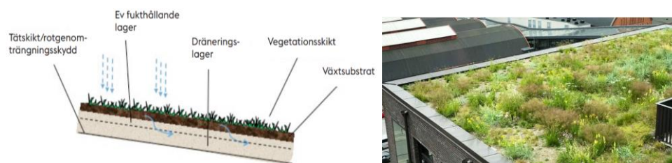
Figur 20. Principskiss för grönt tak i sektion till vänster och exempel på biotoptak till höger (Källor: WRS och VegTech 12,13 )
