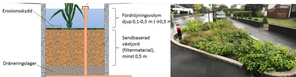
Figur 21. Principskiss för nedsänkt växtbädd till vänster (illustration WRS 15 ) och en nedsänkt växtbädd i gata med kantsläpp (Blomqvist, 2021 16 ).
