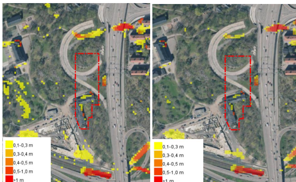
Figur 18. Simulering av maxdjup vid ett 100-årsregn och klimatfaktor 1,25. Maxdjup till vänster och Maxdjup vid simuleringsslut till höger (stående vatten). Ungefärlig utbredning av fastighetsgränsen markeras med röd streckad linje.
