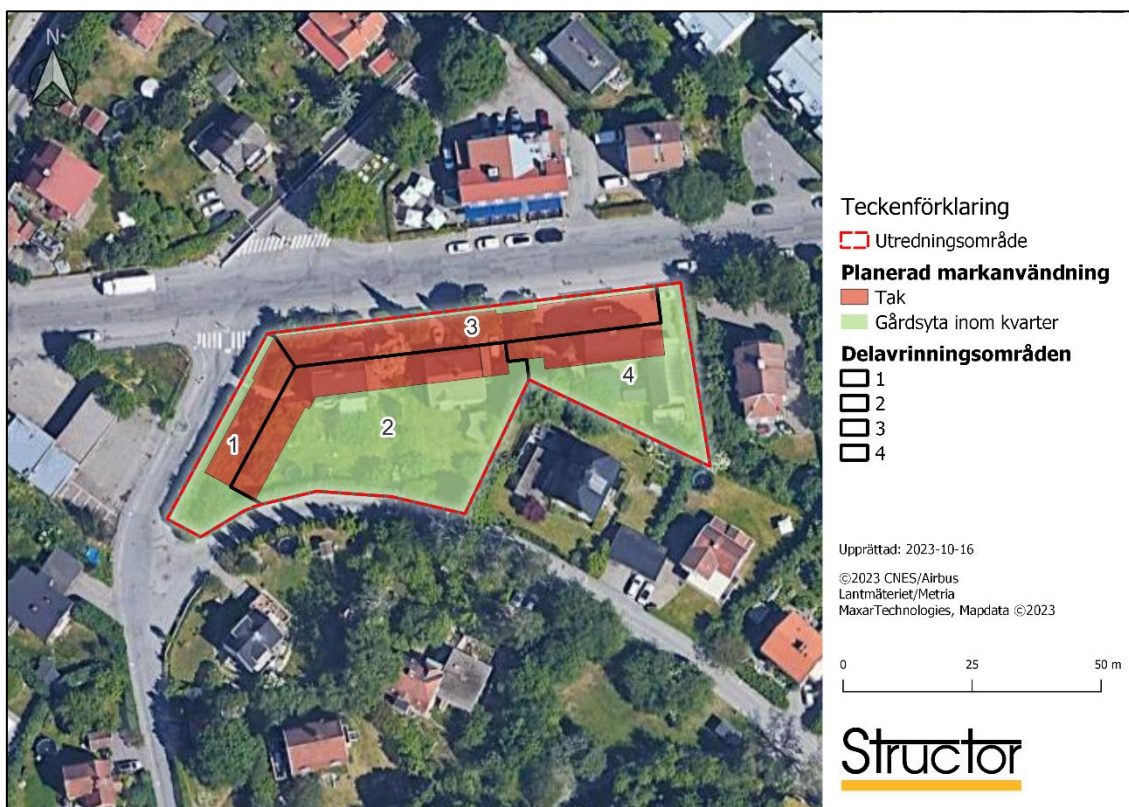
Figur 4-7. Planerad markanvändning i utredningsområdet och indelningen i fyra delavrinningsområden markerade med siffror.
