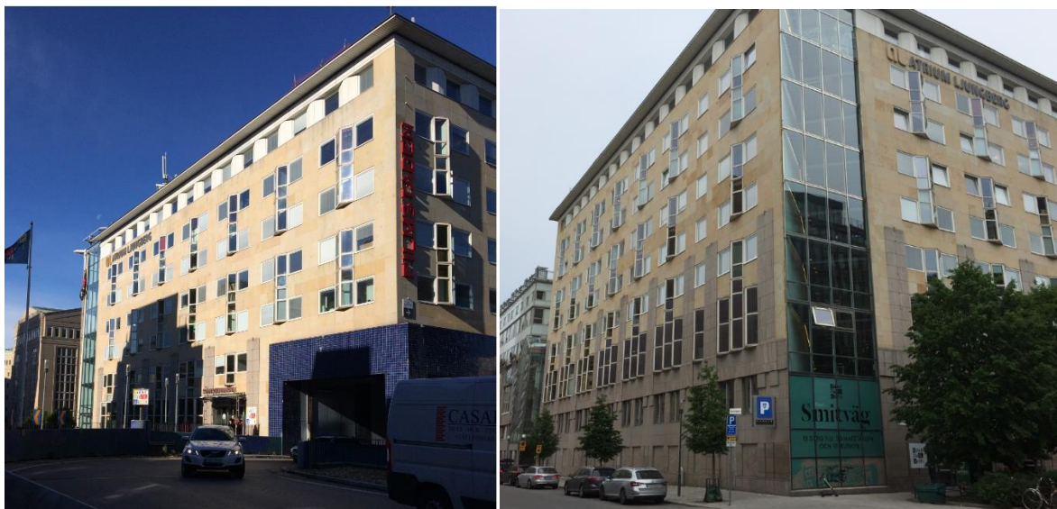
Björkhallens fasad: Fönstren veckas ut i ett litet burspråk som ger djupverkan och släppljus över fasaden. Takfoten är markerad, men bryts av vid de glasade partierna som gör ett diagonalt snitt genom byggnaden och som ger dagsljus in i ljushallen.
