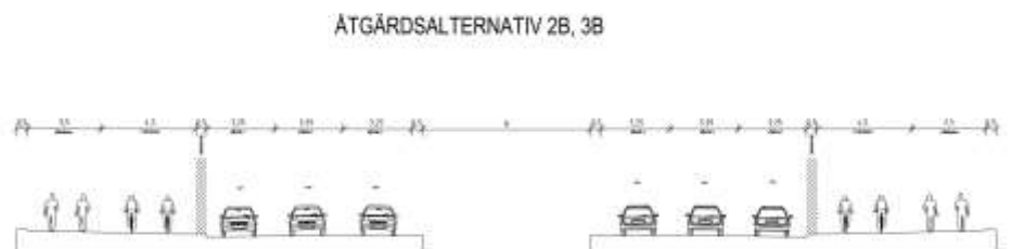
Figur 7. Bred brosektion till alternativen "ny bro" (åtgärdsalternativ 2B och 3B) Fri brobredd 18,25 m+18,25m och 8m mellan broarna.
