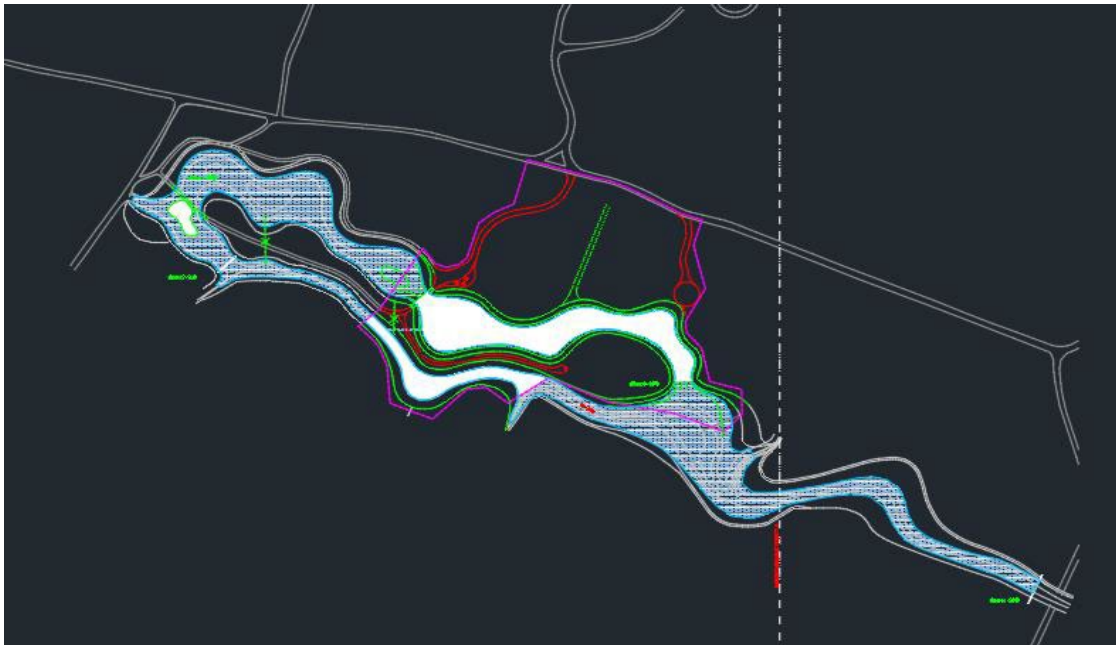
Figur 2. Förslag på ny utformning av anläggningen i Kräppladiket. De vita fälten visar ytvattnets areor av utvidgning av dammanläggningen (översta vita fältet), omdragning av Kräppladiket (nedre vita fältet) respektive muddring i södra dammen (vänstra vita fält).
