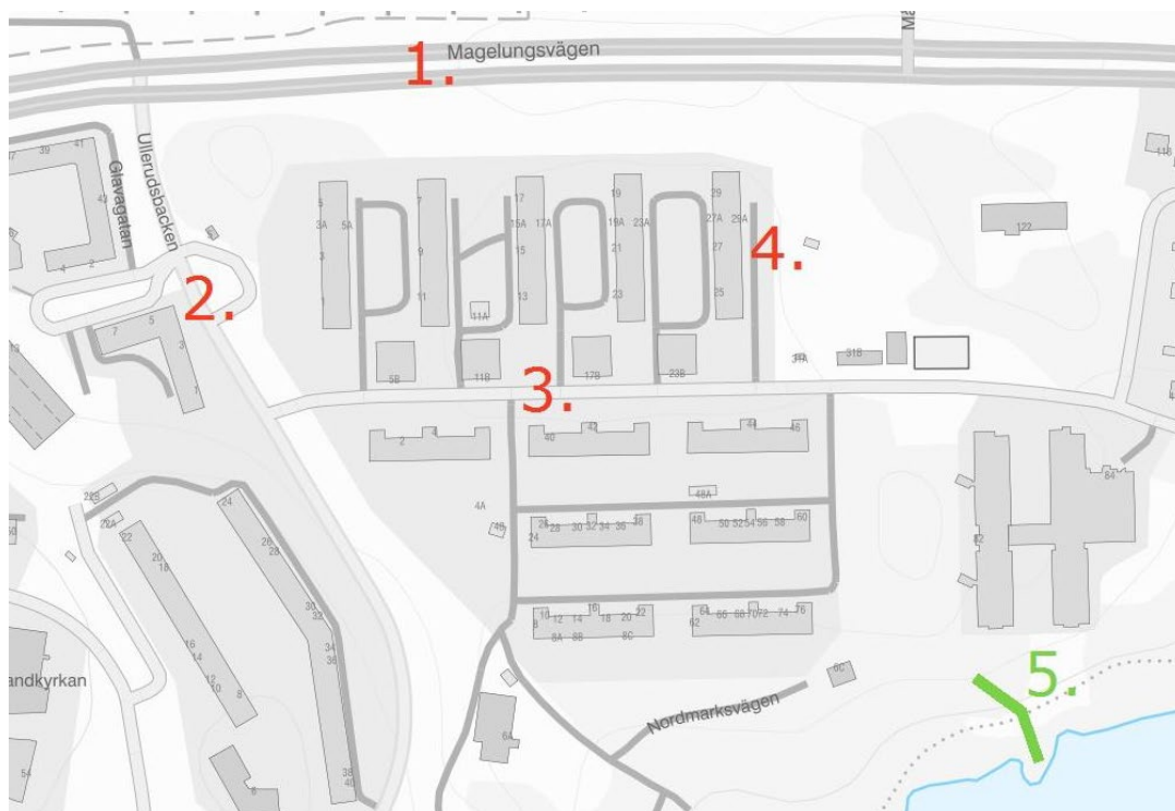
Figur 1. Plankarta för senaste detaljplanen (framtagen: 2020-09-17) för Nordmarksvägen. (1) Magelungsvägen; (2) Ullerudsbacken; (3) Nordmarksvägen; (4) Gång- och cykelväg (GC); (5) Dagvattenledning med okänd kapacitet.
