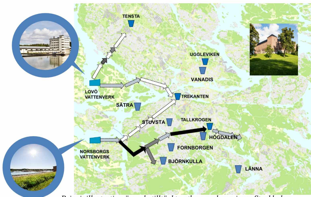
Principillustration över de tilltänkta utbyggnaderna inom Stockholms Framtida Vattenförsörjning.
