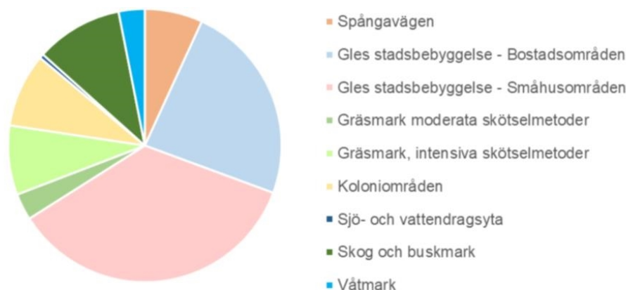
Figur 8. Reducerad area vilket är ett mått på hur mycket av dagvattnet som kommer från en specifik markanvändningsyta till Kyrksjön.
