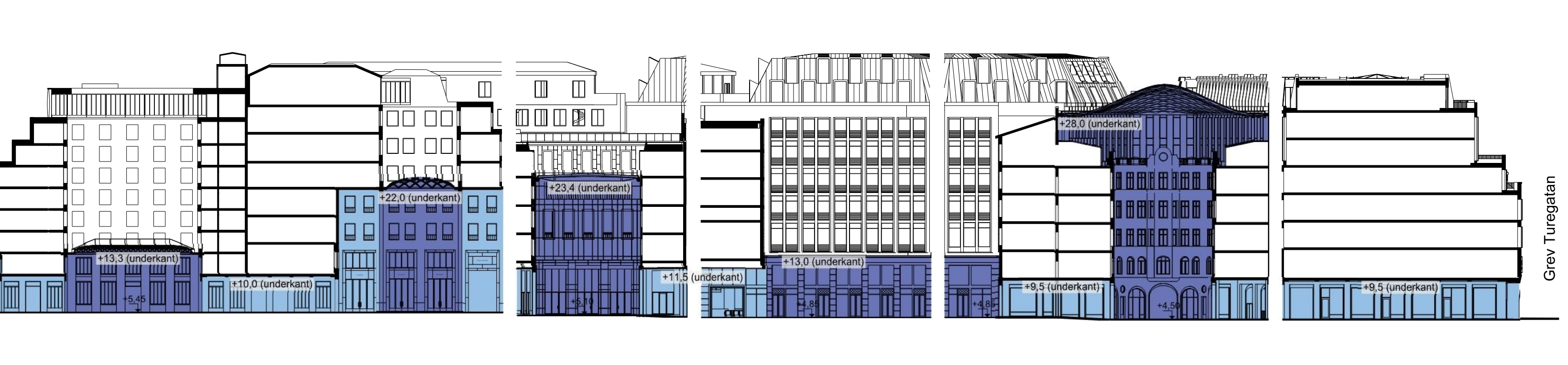
Sektion C-C, galleria med glastak, markerat med mörkblå färg, ska ha en minsta frihöjd i enlighet med denna sektion.
