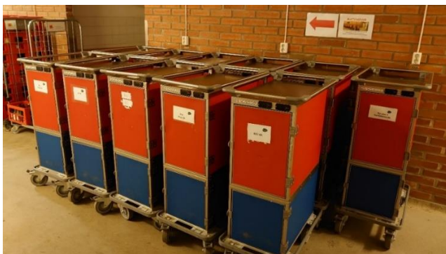
Matvagnar på Rio vård- och omsorgsboende med 88 lägenheter för leverans av varm och kall mat. Matvagnens mått: H 128 cm, B 53 cm, D 81 cm.
