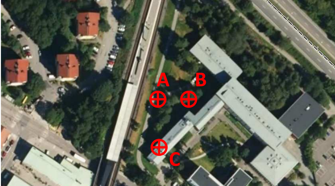
Figur 2. Ungefärliga mätpositioner för vibrationsgivare (accelerometer). Accelerometer på spett i mark (A), på berg i dagen (B) och på bottenplatta inomhus i källare (C). Den lodräta accelerationen mättes för ett antal tågpassager i båda riktningarna för varje mätposition.
