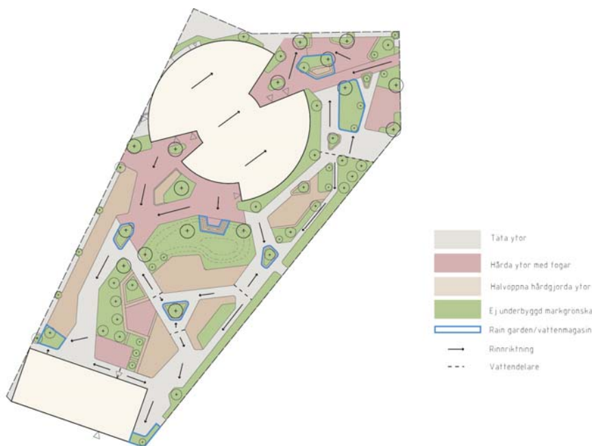
Skolgården är utformad så att alla hårdgjorda ytor leds mot grönytor där rening och fördröjning kan ske.
